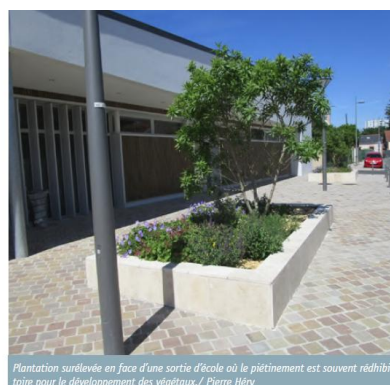
Figure 8 : exemple de délimitation des espaces plantés, limitant le tassement au sol et favorisant l'infiltration en eau
